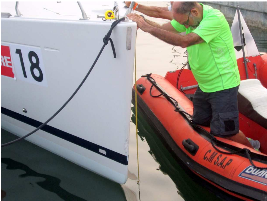
Medición de un francobordo de proa
