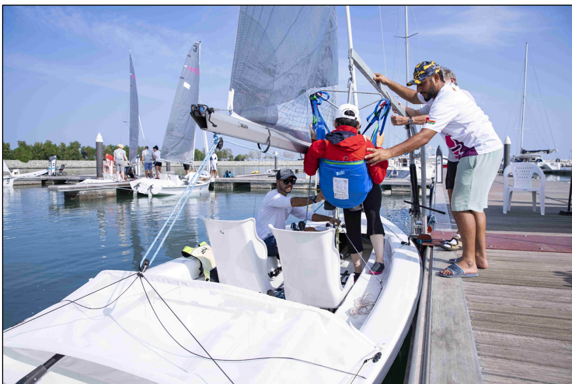
Ilustración 8. Transferencia con grúa desde silla de ruedas a velero RS Venture Connect.
