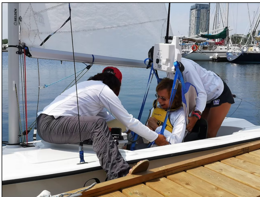
Ilustración 10. La importancia de un pantalán a la altura de la borda de la embarcación.
